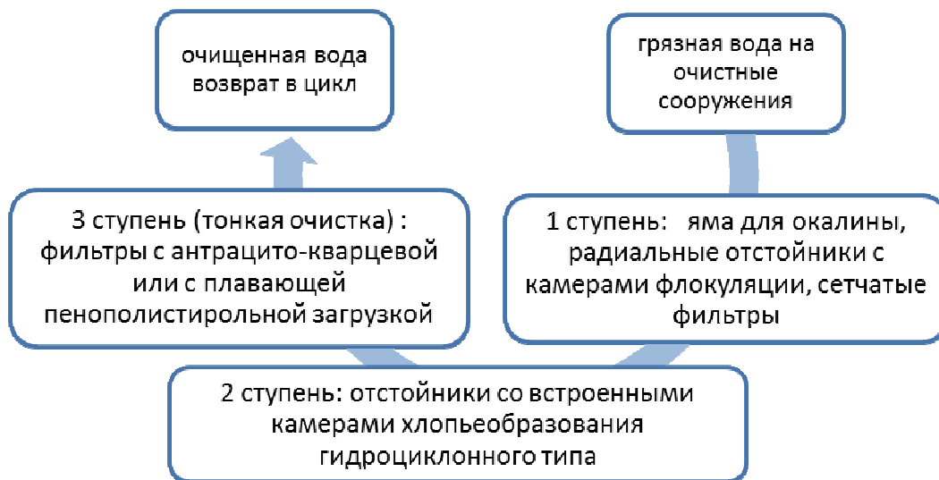
Рисунок 3.3 – Трехступенчатая схема очистки сточных вод станов горячей прокатки
